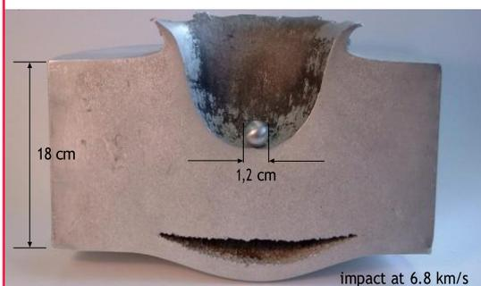
L'image de gauche montre ce qui s'est passé lors des tests effectués sur le matériau d'un vaisseau spatial frappé par un projectile rapide. Le module de service européen Orion constitue une structure solide recouverte de nombreuses couches de matériaux qui contribuent à réduire les dommages causés par de tels impacts.
