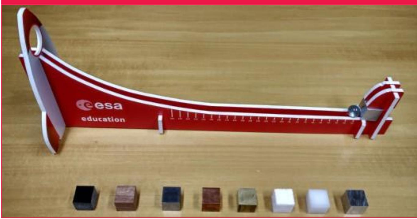
↑ Installation pour le test d'impact
