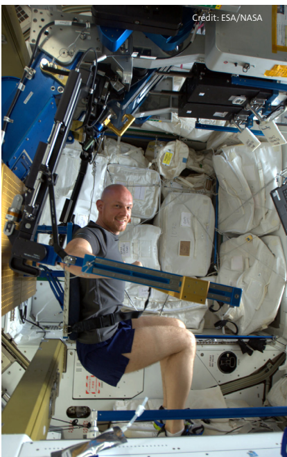
↑ L'astronaute de l'ESA Alexander Gerst utilise l'ARED (Advanced Resistive Exercise Device) de la station spatiale internationale pour rester en forme en simulant des exercices d'haltérophilie en utilisant la pression de l'air au lieu des poids traditionnels.
