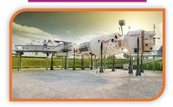
Il s'agit d'un modèle réel ayant servi aux tests de résistance pour la vraie station spatiale russe MIR. Elle est à taille réelle.
