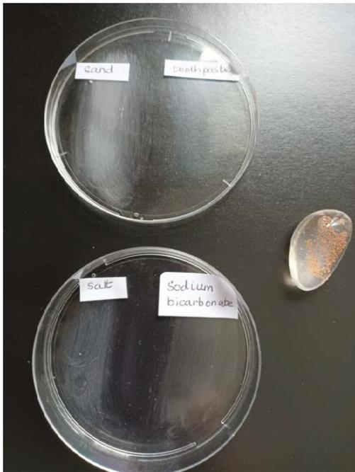
L'image montre les résultats pour quatre produits testés sur la surface d'une boîte de Pétri, ainsi que la surface d'un galet de verre préparée avec du sable avant le polissage.
