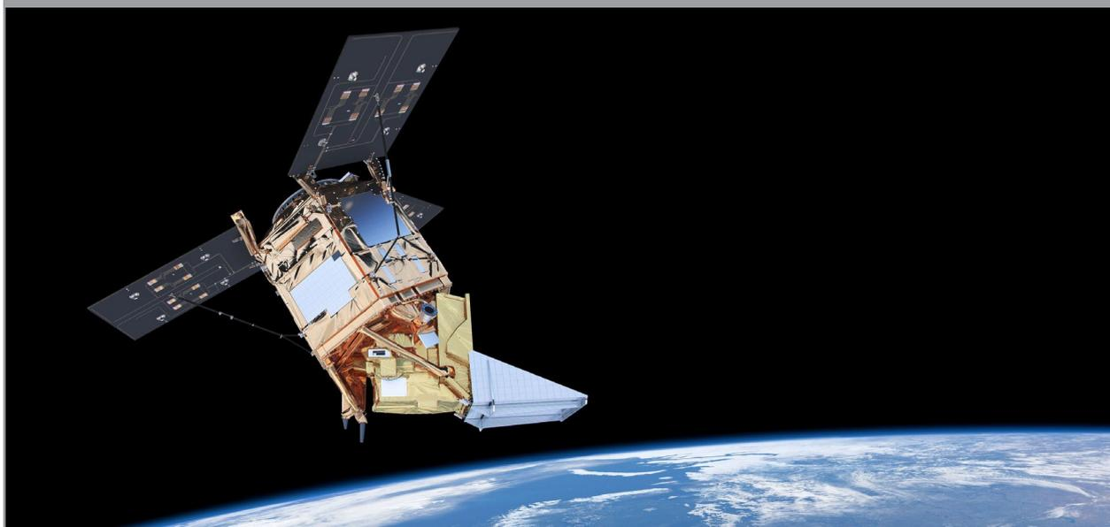
↑ Le satellite Sentinel-5P du programme Copernicus est équipé de l'instrument de pointe TROPOMI qui cartographie un grand nombre de gaz présents dans l'atmosphère à l'état de traces – tels que le dioxyde d'azote, le méthane, le monoxyde de carbone et les aérosols – qui ont tous une incidence sur l'air que nous respirons, et donc sur notre santé et notre climat
