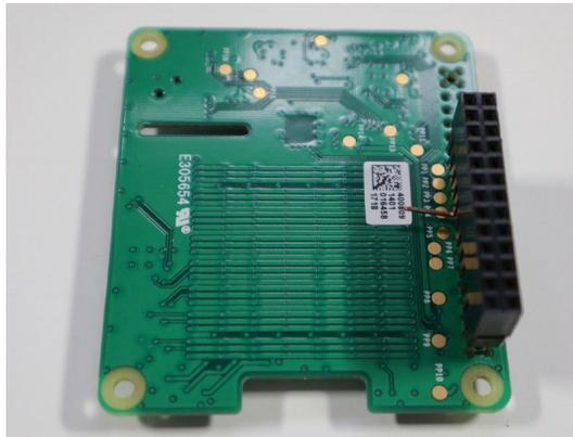
Connecte le fil 3V3 restant du capteur PIR à la broche coudée sur le connecteur.
