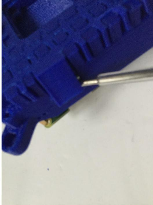
Enfin, l'échafaudage de base devrait se détacher facilement si tu le retires par sections. Avant de commencer, utilise avec précaution un cutter ou un scalpel pour séparer les côtés des ailettes de l'échafaudage.
