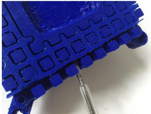
Une fois que tu as coupé l'échafaudage en sections et que tu as séparé chaque pièce du reste et de la base, fais glisser délicatement l'échafaudage en le décollant des ailettes. Tu peux utiliser un cutter pour découper l'échafaudage en sections afin de pouvoir le retirer facilement par étapes.
