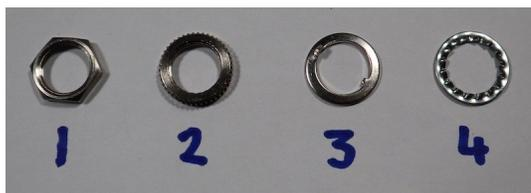
Repositionne d'abord le clip de blocage (3), puis l'écrou de blocage hexagonal (1). Tu peux te débarrasser de la bague de retenue (4).
