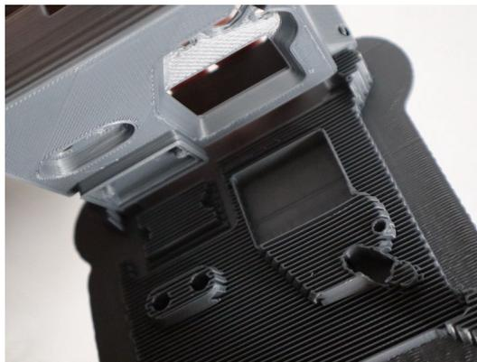
Si tu n'as pas utilisé de radeau pour ton impression, il y a trois principales zones d'échafaudage à manipuler.
