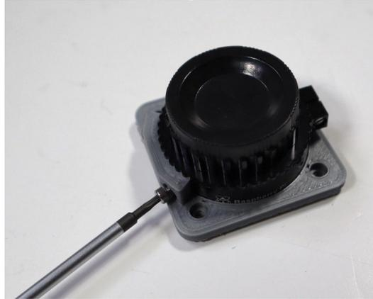
Repositionne le boîtier principal sur le circuit imprimé. Assure-toi d'aligner le boîtier à l'aide d'un joint qui reste sur la carte de circuit imprimé.
