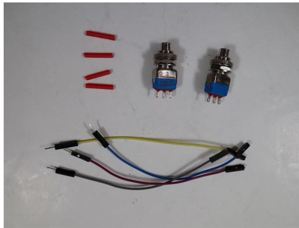
Prends un fil de couleur et retire la gaine en plastique noir sur une extrémité. Si ton fil a une extrémité pointue (M), et une extrémité avec un trou (F), tu dois retirer le connecteur à l'extrémité M. Tu peux le faire en le retirant avec une pince ou en coupant le fil juste en dessous du connecteur. Dénude environ 1 cm de la gaine isolante de ton fil. Répète cette opération pour trois autres fils.
