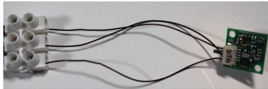
Connecte trois fils de connexion Dupont M-F individuels à l'autre côté du bloc de connexion. Tu devrais pouvoir visser sur la partie pointue de l'extrémité M de chaque fil.
