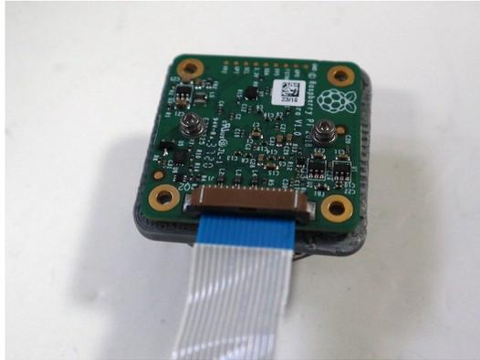
Glisse le câble à travers la fente de la base. Assure-toi d'avoir la bonne orientation afin que le côté bleu soit orienté vers le bas du boîtier lorsqu'il est replié.
