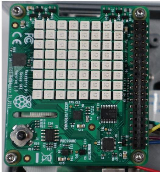
Pour vérifier que le Sense HAT est correctement connecté, il est conseillé à ce stade d'insérer une carte SD amorçable dans le Raspberry Pi et de connecter le câble d'alimentation USB-C.
