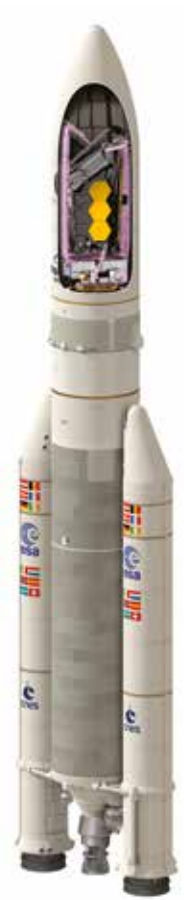
Le télescope Webb replié à l'intérieur de la coiffe de la fusée Ariane 5 fournie par l'ESA.
