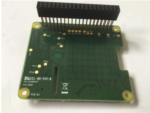
Enfonce l'embase jusqu'au bout. Vérifie qu'aucune des broches n'est obstruée et qu'elles sont alignées correctement afin de ne pas se plier.
