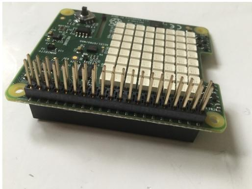
Fais passer le câble de la caméra à travers la fente du Sense HAT, puis place le Sense HAT sur le dispositif Raspberry Pi. Vérifie que les 40 broches GPIO sont alignées avec les trous correspondants de la grande embase.
