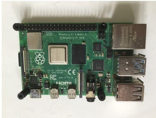
Insère le câble de la caméra dans la prise CSI (Camera Serial Interface) du Raspberry Pi.
