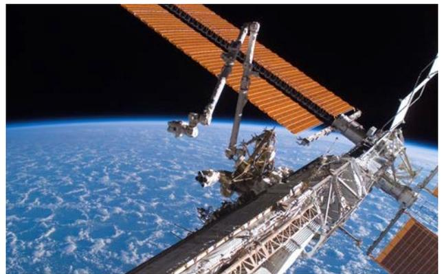
Le Canadarm2 (au centre) et les ailes de panneaux solaires de l'ISS.
