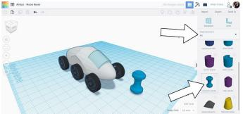
En faisant glisser le cylindre multipoint dans le plan de construction, nous pouvons apporter nos modifications. Pivotez la forme de manière à ce que la longueur du cylindre soit perpendiculaire au corps du rover, puis positionnez-le devant le rover.
