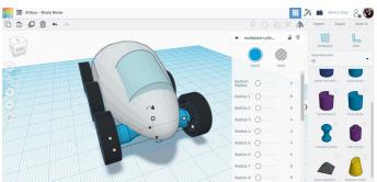
Une fois l'alignement terminé, nous pouvons positionner l'essieu. Pour cela, maintenez la touche Maj enfoncée pour limiter le mouvement le long d'un axe, ce qui permet de préserver l'alignement que nous venons de réaliser.
