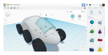
Le cockpit a été posé sur le corps en le faisant glisser, puis la flèche de hauteur a été utilisée pour obtenir la hauteur souhaitée. Les flèches de rotation ont été utilisée pour pivoter la forme de manière à suivre le profil du corps.
