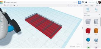
Lorsque j'ai été satisfait du positionnement, j'ai créé une copie (Ctrl+D), puis j'ai déplacé manuellement le panneau solaire de l'autre côté, en maintenant la touche Maj enfoncée pour limiter le mouvement le long de l'axe.
