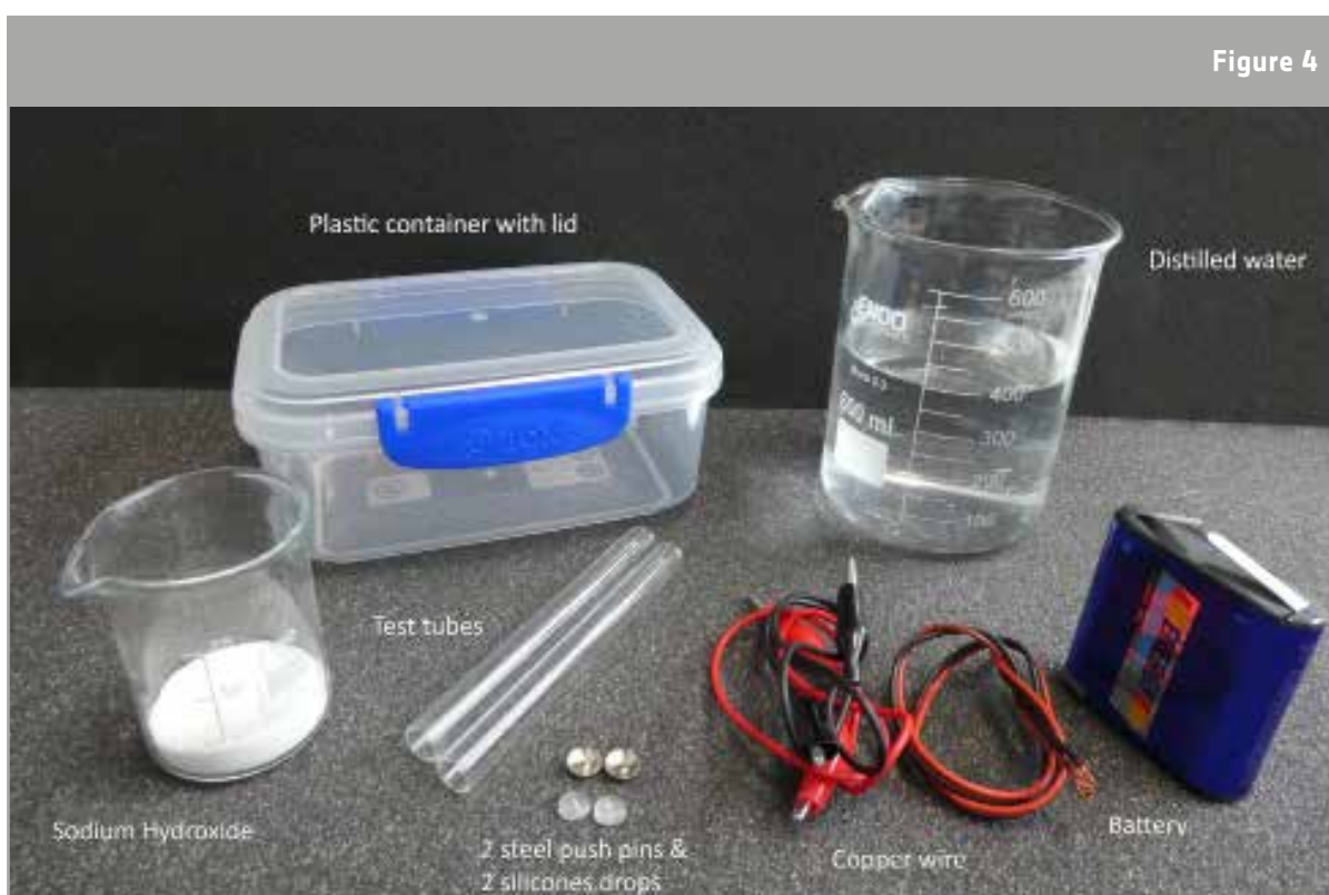
↑ Matériel nécessaire à la construction d'un électrolyseur
